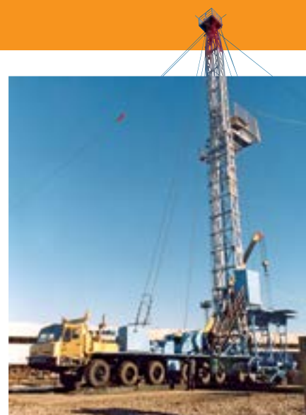
Мобильная буровая установка МБУ-125 на шасси внедорожного тягача БАЗ-69099
