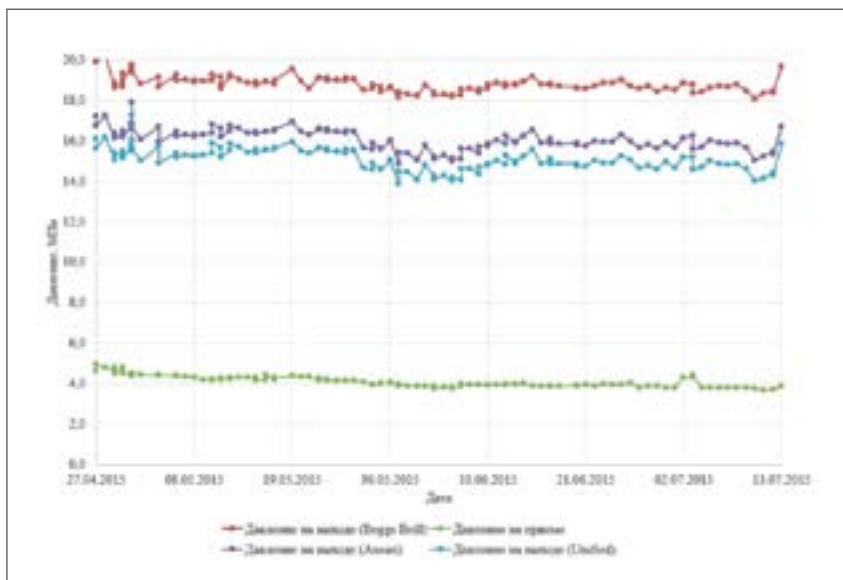
Рис. 2. Сравнение расчетных давлений на выходе насоса при использовании разных методик
