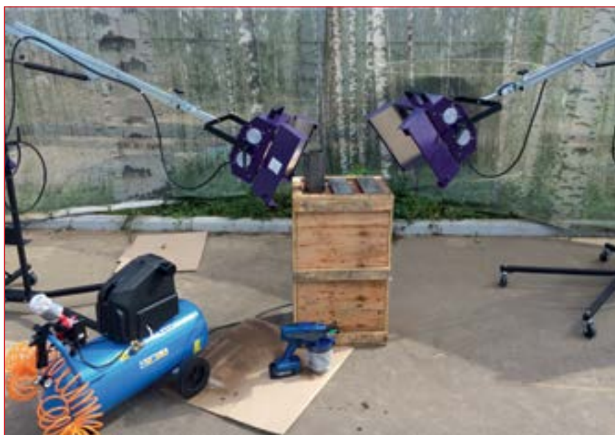
Рис. 2. УФ-отверждение AdvenGuard™ в камере (1), в помещении (2) и на улице (3)
