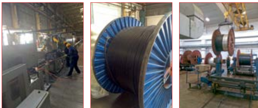
Рис. 4. Изготовление КПв0ппП и подготовка к спуску
