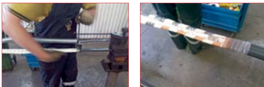
Рис. 5. Сращивание кабеля с полимерной броней со стандартным удлинителем
