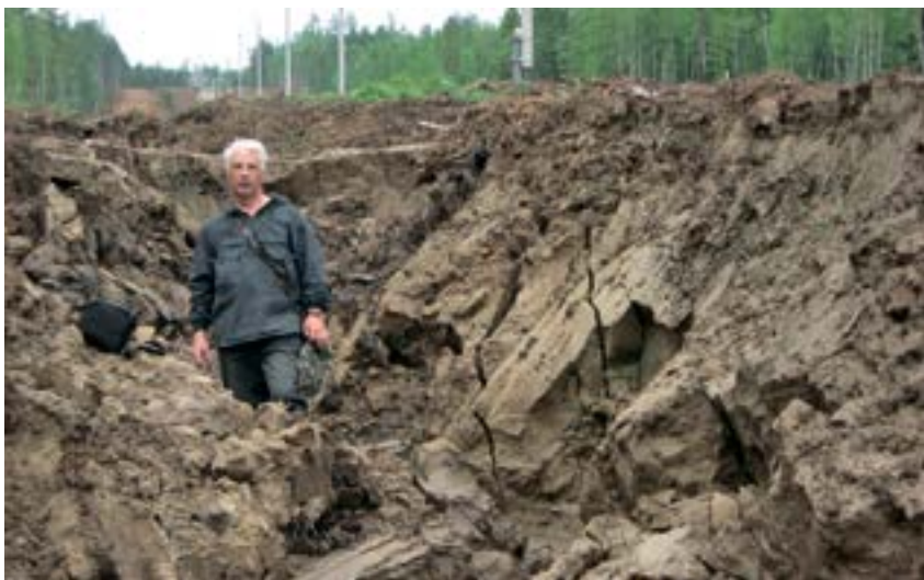
Рис. 3. Активная термоэрозия в средней части трассы, 2011 г. Фото: И.В. Дорофеев Fig. 3. Active thermal erosion in the middle part of the route, 2011. Photo: I.V. Dorofeev
