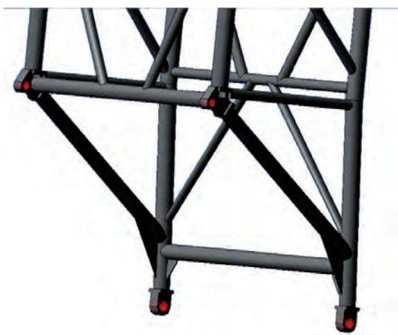
Рис. 3. Схема закрепления вышечной конструкции
