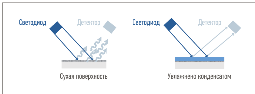
Рис. 3. Оптическая схема регистрации слоя углеводородного конденсата на охлаждаемом зеркале в гигрометре Ametek model 241CE II
