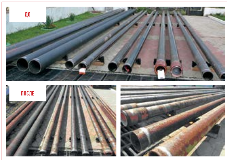
Рис. 1. Внешний вид труб с консервационными покрытиями до и после проведения натуральных и натурно-ускоренных испытаний
