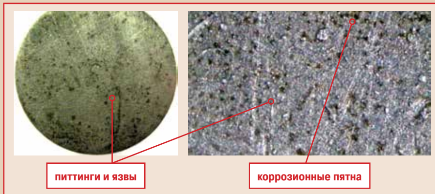
Рис. 15. Поверхность 15X2ГМФ после коррозионных испытаний в МПВ, насыщенном углекислым газом, x44
