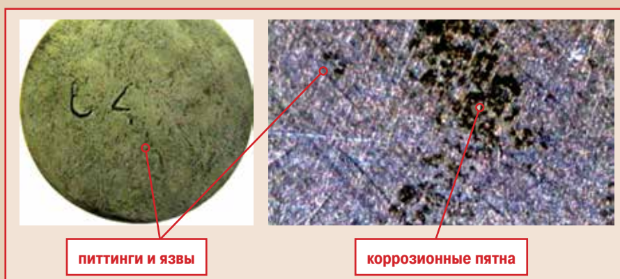
Рис. 16. Поверхность 40ХГМ после коррозионных испытаний в МПВ, насыщенном углекислым газом
