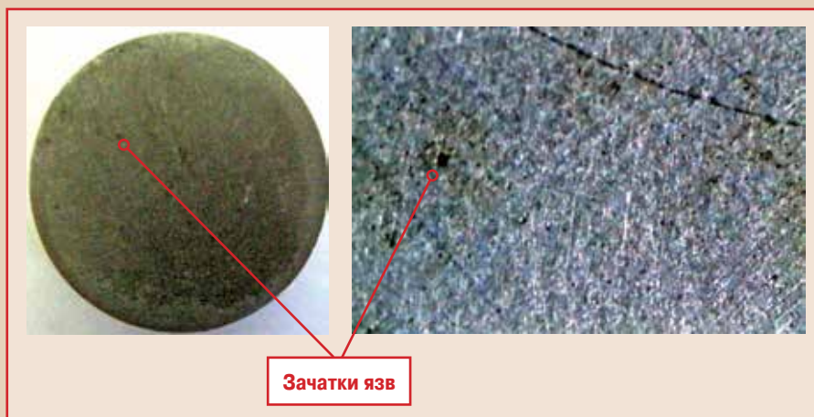
Рис. 11. Поверхность стали 20X13 после коррозионных испытаний в МПВ, насыщенной углекислым газом, x44
