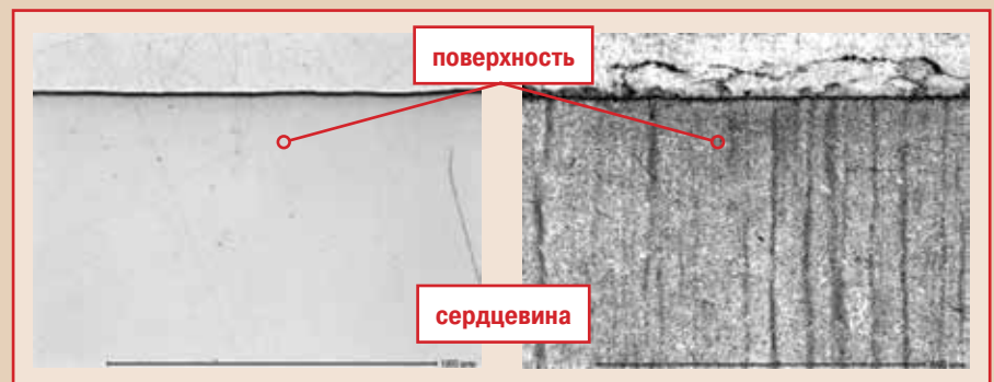
Рис. 13. Микроструктура 20Х13 после коррозионных испытаний в МПВ, насыщенной углекислым газом, х100
