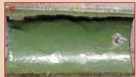
Рис. 7. а) Покрытие 1, б) Покрытие 2, в) Покрытие 3 после испытания на стойкость к взрывной декомпрессии по методике испытаний согласно Приложению Б
