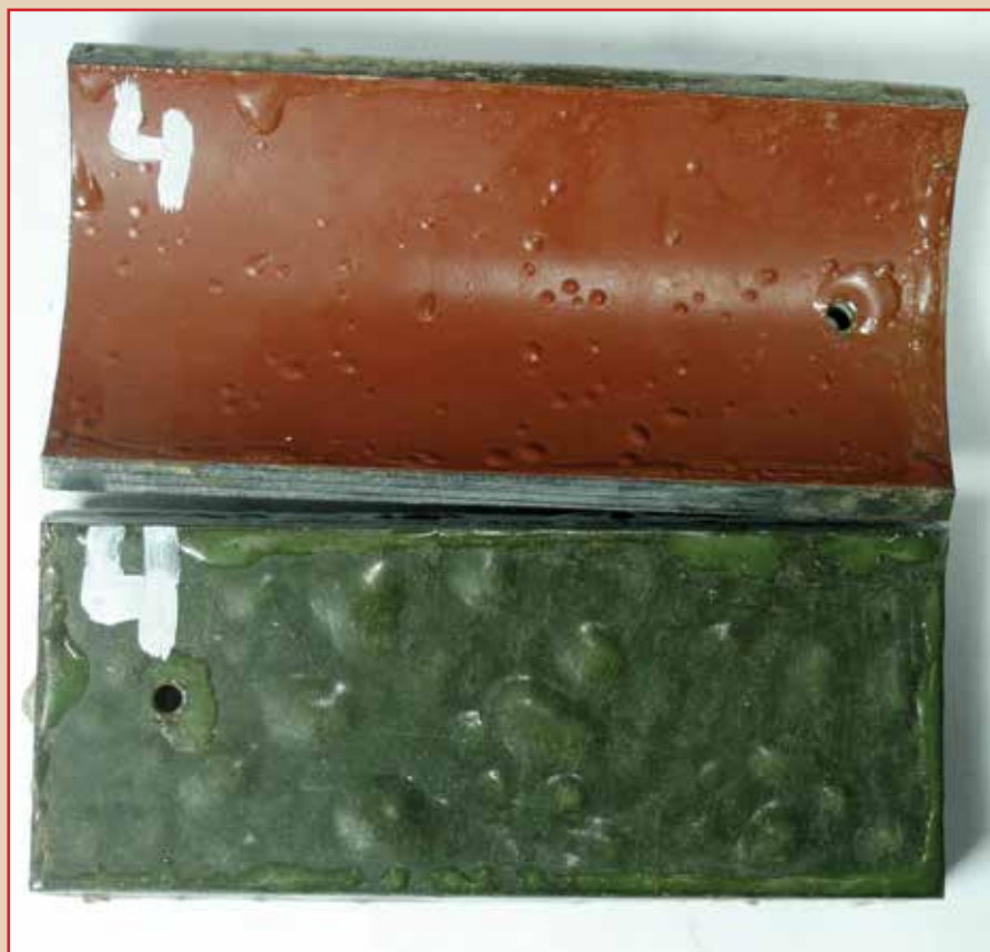
Рис. 5. Внешний вид покрытий после выдержки в автоклаве при температуре 80 °С, давлении 30 атм., 24 часа в CO 2 -насыщенной среде
