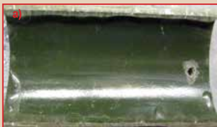
Рис. 7. а) Покрытие 1, б) Покрытие 2, в) Покрытие 3 после испытания на стойкость к взрывной декомпрессии по методике испытаний согласно Приложению Б
