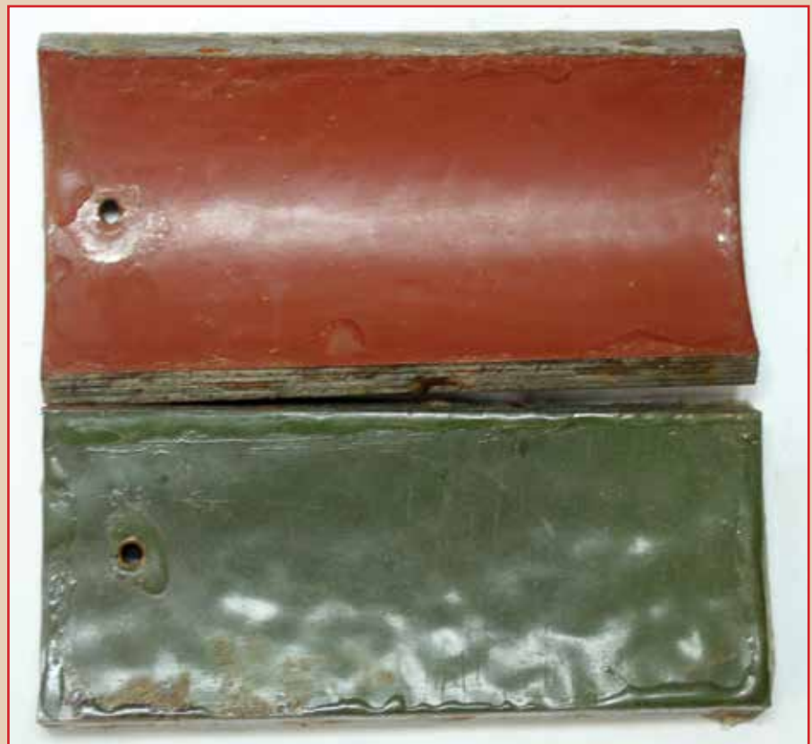
Рис. 6. Внешний вид покрытий после выдержки в автоклаве при температуре 80 °С, давлении 100 атм., 48 часов в N 2 -насыщенной среде
