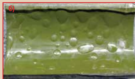
Рис. 7. а) Покрытие 1, б) Покрытие 2, в) Покрытие 3 после испытания на стойкость к взрывной декомпрессии по методике испытаний согласно Приложению Б
