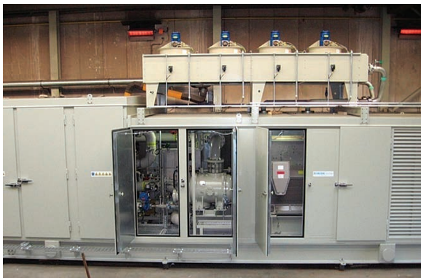
Рис. 4. Мобильная компрессорная установка блочно-модульного исполнения
