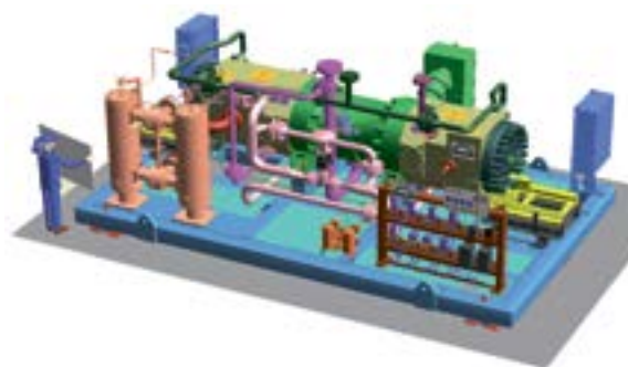
Рис. 2. Технологическая компоновка моноблочных ЭГПА
