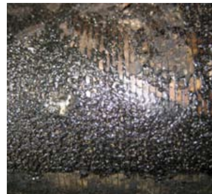
Рис. 2. Фильтрующий элемент УЭЦН с наработкой 4 суток (причина остановки – засорение ЭЦН механическими примесями)
