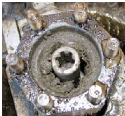
Рис. 1. Демонтаж УЭЦН на устье скважины Западной Сибири (причина остановки – засорение ЭЦН механическими примесями)
