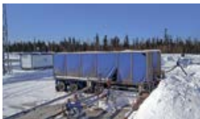
Рис. 1. Работа мобильной газосепарационной установки с использованием манифольда
