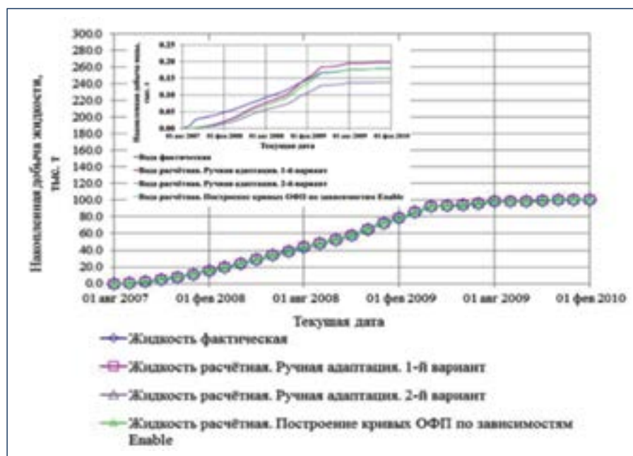
Рис. 2. Сопоставление фактических и расчетных значений накопленной добычи жидкости и воды
