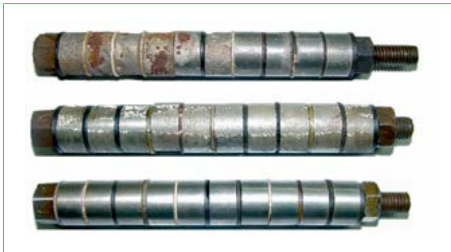
Рис. 5. Гравиметрические кассеты с равномерной, слабо проявленной и ярко выраженной локальной коррозией
