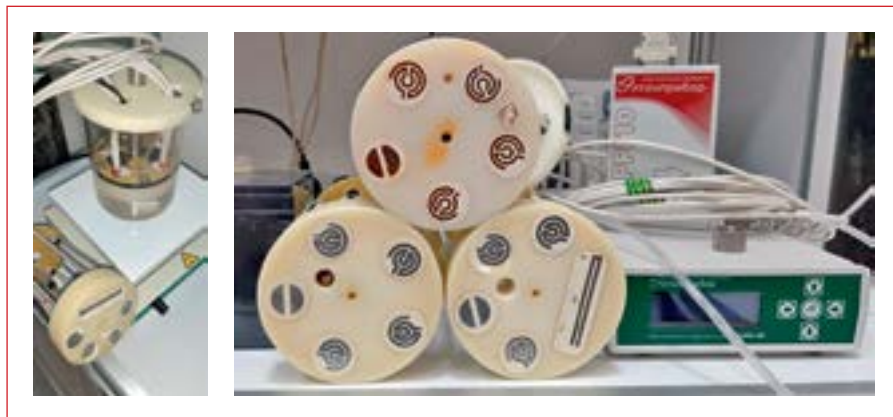
Рис. 8. Лабораторные зонды для комплексной проверки качества ингибиторов прямым (с помощью электронного аналога гравиметрической кассеты) и комбинированными методами
