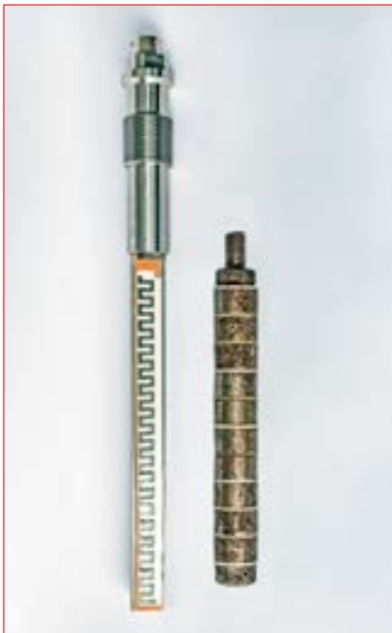
Рис. 2. Зонд электронного аналога гравиметрической кассеты и гравиметрическая кассета с проявлениями локальной коррозии
