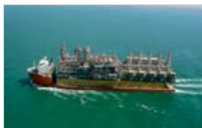
Рис. 6. Транспортировка плавучей конструкции линии по сжижению общей массой 24 тыс. т
