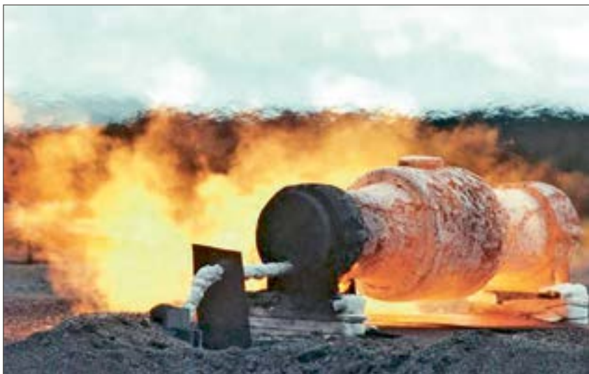
Рис. 3. Испытание покрытия Chartek 7 в условиях горения углеводородного топлива под давлением
