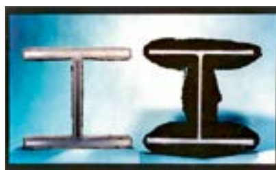
Рис. 2. Двутавровая балка, окрашенная эпоксидным вспучивающимся покрытием Chartek® до и после воздействия огня с образовавшимся слоем карбонизированной пены
