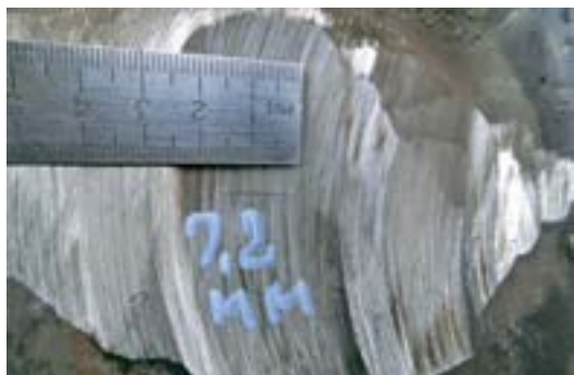
Рис. 1. Подтверждение на кольцевом сварном шве трещин типа Еб, выявленных прибором поперечного намагничивания ДМТП
