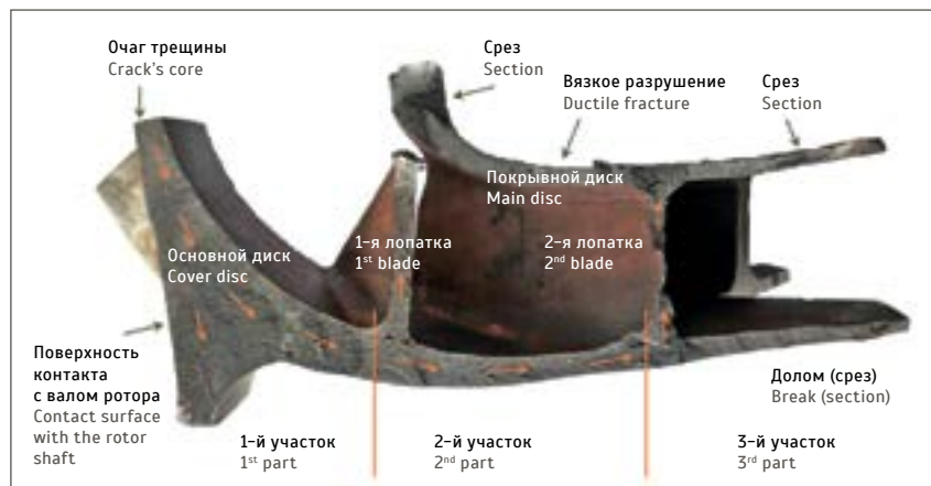
Рис. 5. Развитие разрушения колеса 1-й ступени Fig. 5. Development of the 1st stage wheel fracture
