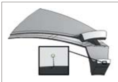
Рис. 9. Трещина на торцевой поверхности ступицы колеса 3-й ступени Fig. 9. A crack at the end surface of the 3rd stage wheel hub
