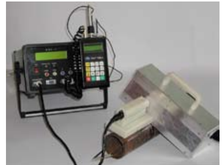
Рисунок 8. Прибор для определения физико-механических свойств материалов металлоконструкций ФМХ-1
