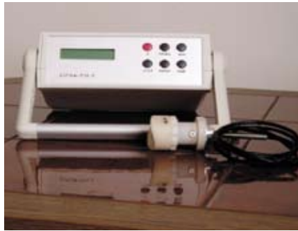
Рисунок 7. Прибор для определения физико-механических характеристик стальных бурильных и насосно-компрессорных труб СИГМА-Т
