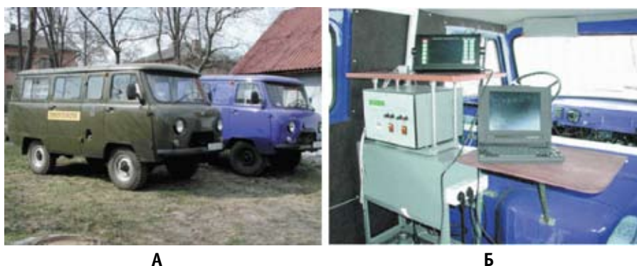
Рисунок 4. Передвижная лаборатория ПЛНК-9 (а) и ее внутренний интерьер (б)
