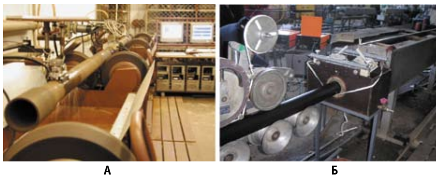
Рисунок 3. Стационарная дефектоскопическая установка для комплексного механизированного контроля труб С0Т –1 (а); и колтюбинговых труб (б)
