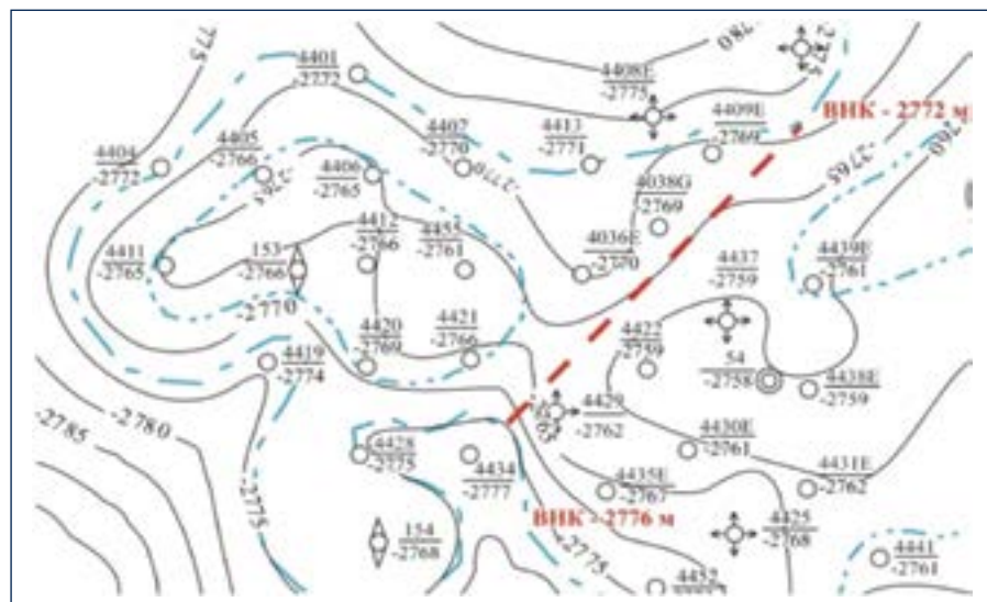
Рис. 8. Структурная карта кровли пласта-коллектора с предполагаемым геологическим барьером Fig. 8. Structural map of reservoir roof with an estimated geological barrier
