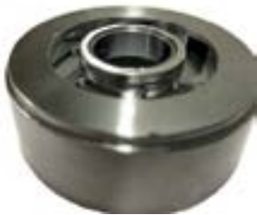
Рис. 1. Направляющий аппарат и рабочее колесо ЭЦН02А-25, выполненные из стали 40Х13, до опытно-промышленных испытаний Fig. 1. Diffuser and impeller of ETcN02A-25 pump stages, made of stainless steel AISI 420, before pilot testing
