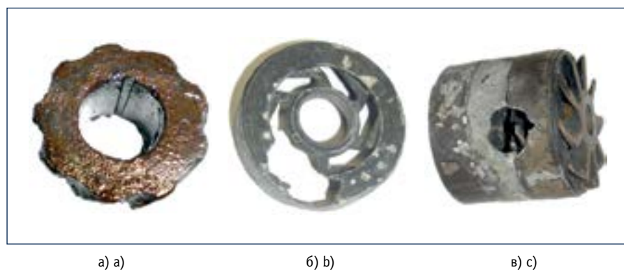
Рис. 4. Рабочие органы ступени ЭЦН02А-25 из алюминиевого сплава В-95-1: а) рабочее колесо; б) направляющий аппарат; в) сборка нескольких ступеней Fig. 4. Working bodies of ETcN02A-25 pump stages, made of aluminium alloy AA7075: a) impeller; b) diffuser; c) multi-stage assembly
