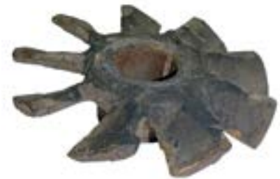
Рис. 3. Неочищенное рабочее колесо ЭЦН02А-25 после опытно-промышленных испытаний Fig. 3. Uncleaned impeller of ETcN02A-25 pump stages after pilot testing
