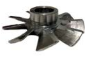
Рис. 1. Направляющий аппарат и рабочее колесо ЭЦН02А-25, выполненные из стали 40Х13, до опытно-промышленных испытаний Fig. 1. Diffuser and impeller of ETcN02A-25 pump stages, made of stainless steel AISI 420, before pilot testing
