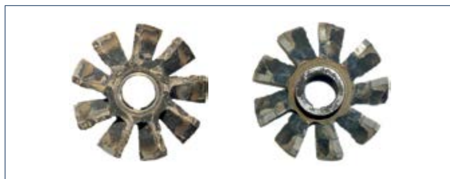
Рис. 5. Рабочие колеса ступени ЭЦН02А-25 из стали 40Х13 Fig. 5. Impellers of ETcN02A-25 pump stages, made of stainless steel AISI 420
