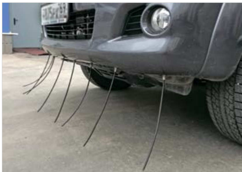
Фото 3. Пробоотборная система течеискателя. Коридор отбора 14 м
