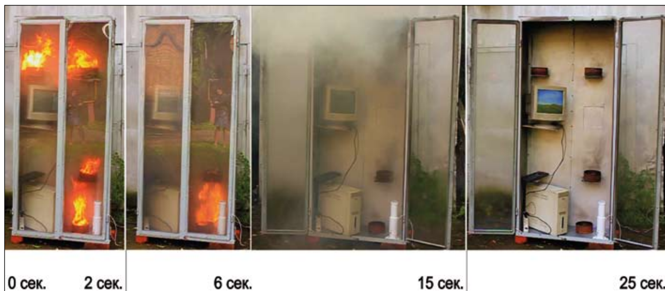
Рис. 2. Испытание ГПТ-1,0 в прозрачном шкафу
