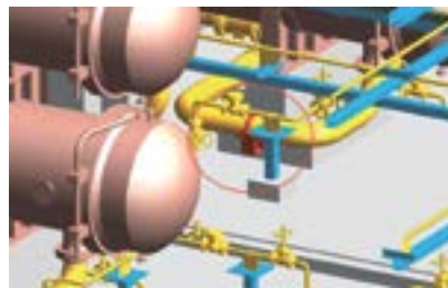
Рис. 8. Выявление недоработки при проектировании с помощью трехмерных технологий Fig. 8. Identification of defects in the design using 3D technology
