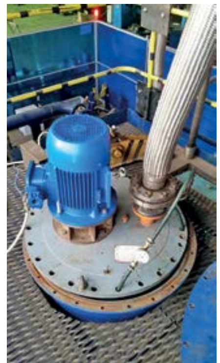
Рис. 4. Агрегат электронасосный ЦМП на испытательном стенде Fig. 4. Electric pump TsMP on the test bench
