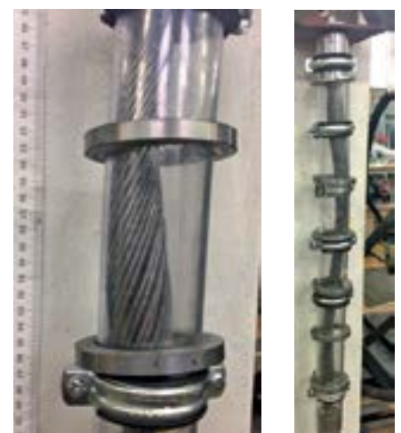
Рис. 6. Увеличение зазора между проволоками и отслаивание наружного слоя в результате испытания образца пластически обжатого каната d = 21,7 мм
