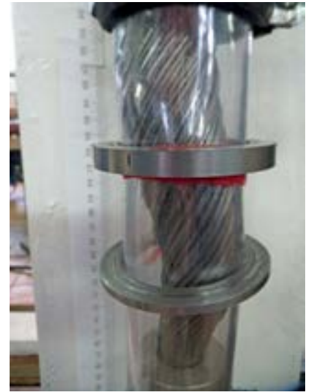
Рис. 4. Испытание образца каната закрытой конструкции d = 20 мм с фигурными Z-образными проволоками
