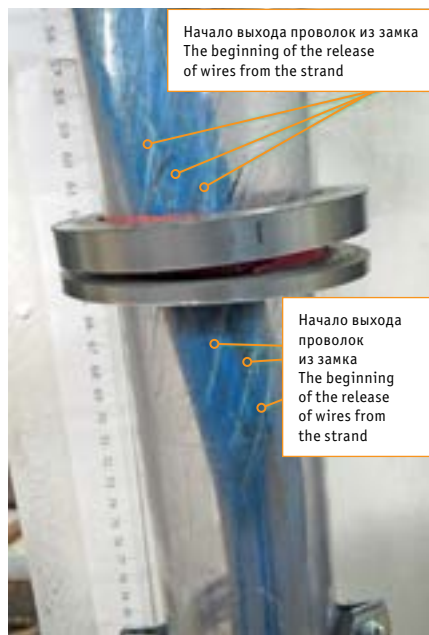
Рис. 7. Испытание образца каната закрытой конструкции d = 20 мм с полимерным покрытием Fig. 7. The test of the sample of the cable closed design d = 20 mm with a polymer coating
