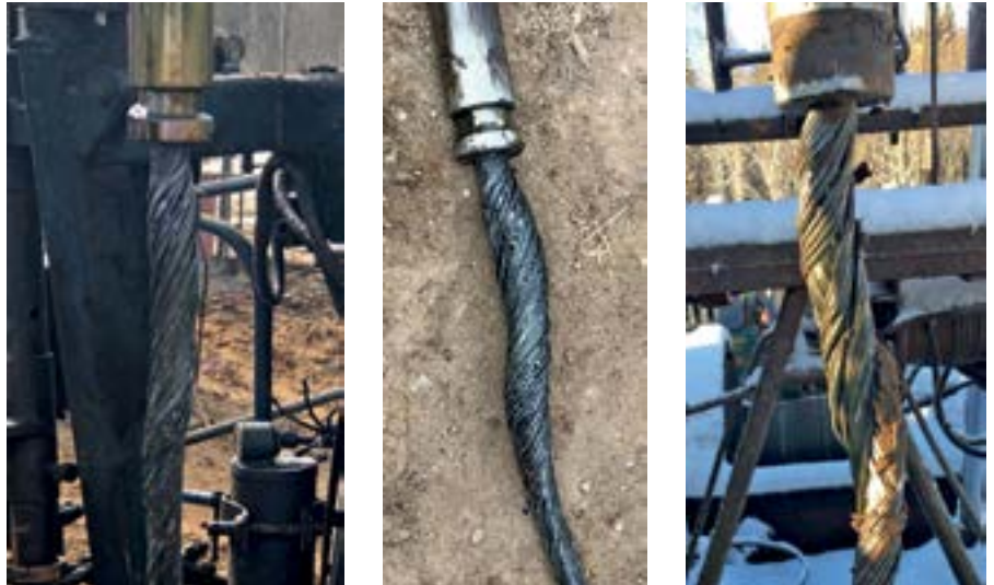
Рис. 1. Потеря устойчивости (распушение) канатной штанги в скважине в процессе эксплуатации под действием сжимающих нагрузок
