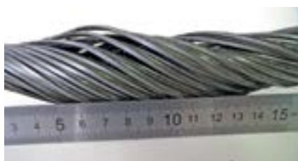
Рис. 5. Остаточная деформация проволок образца каната закрытой конструкции d = 20 мм с фигурными Z-образными проволоками
