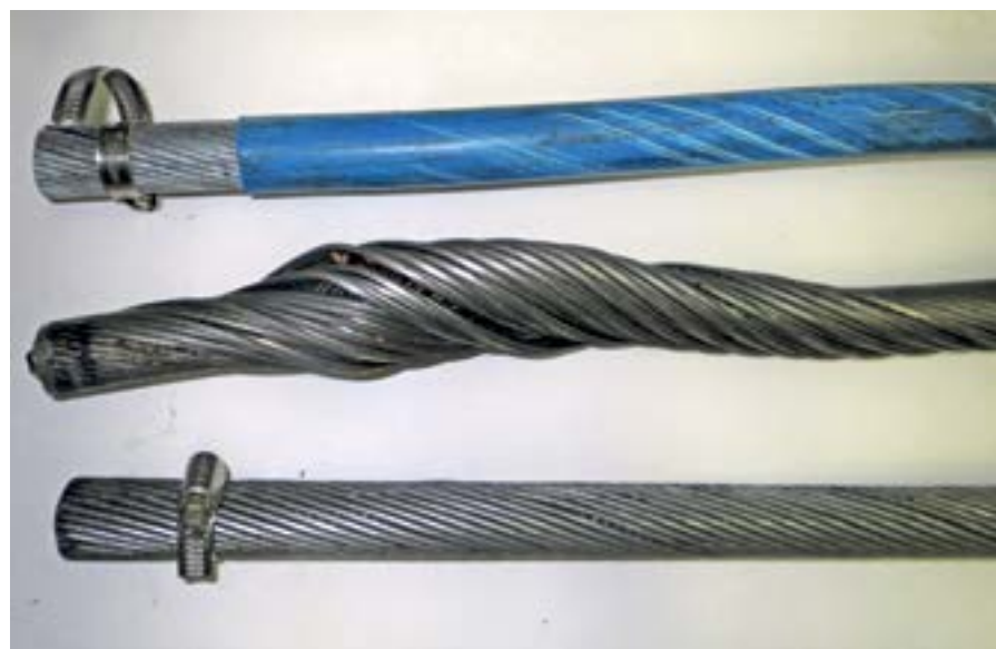
Рис. 8. Образцы канатов после проведения прочностных испытаний (сверху вниз): пластически обжатый канат; канат закрытой конструкции; канат с полимерным покрытием Fig. 8. Samples of ropes after carrying out strength tests (from top downward): plastically compressed rope; rope of a closed structure; rope with a polymer coating
