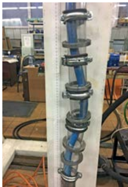
Рис. 7. Испытание образца каната закрытой конструкции d = 20 мм с полимерным покрытием Fig. 7. The test of the sample of the cable closed design d = 20 mm with a polymer coating
