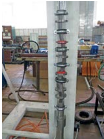
Рис. 4. Испытание образца каната закрытой конструкции d = 20 мм с фигурными Z-образными проволоками
