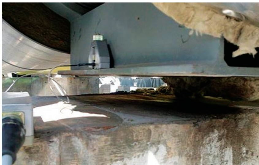
Рис. 3. Периодические подъемы участков коллектора газа регенерации в районе хомутовой опоры
