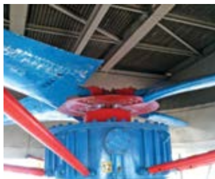
Рис. 2. Композитное рабочее колесо ГАЦ-50-4М2 Fig. 2. Composite impeller ГАЦ-50-4М2
