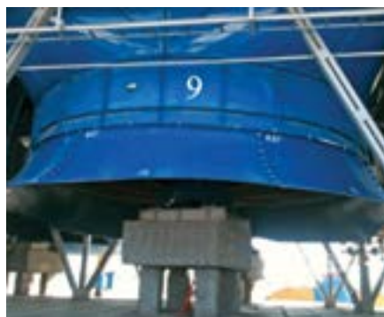
Рис. 1. Коллектор плавного входа ГАЦ-50К Fig. 1. Soft start collector ГАЦ-50К
