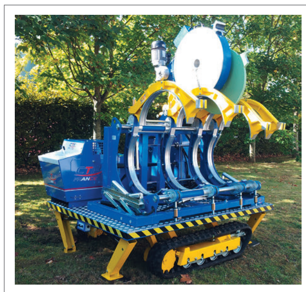
Рис. 2. Гидравлический привод всех подвижных элементов TRANSPILLOT 630
