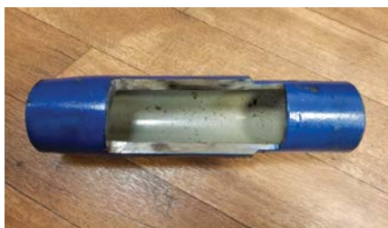
Рис. 1. Механическое соединение Sure-Lock
