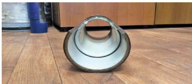
Рис. 2. Труба с внутренним полимерным антикоррозионным покрытием (ППТ) со втулкой
