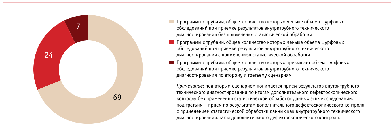
Рис. 2. Соотношение количества труб по программам обследования потенциально опасных участков в шурфах с требуемыми объемами шурфовых обследований, %
