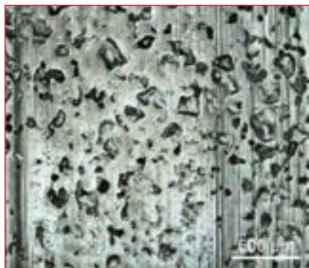
Рис. 2. Выполненный с помощью оптического микроскопа снимок следа износа обработанной стали 12X13 ( T = 120^\circ\text{C} , P = 1,5\text{ ГПа} , 10 млн циклов, скольжение-качение)
