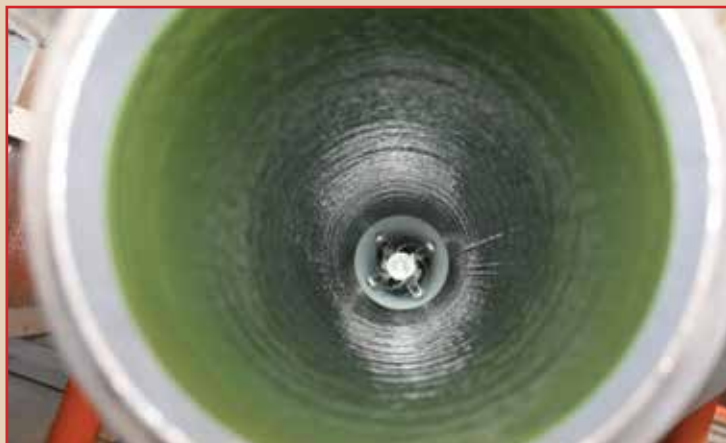
Фото 2. Внутреннее антикоррозионное покрытие. Процесс нанесения
