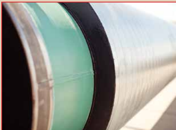
Фото 1. Внешнее антикоррозионное покрытие
