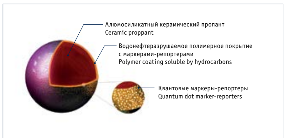
Рис. 1. Зерно маркированного полимерно-покрытого пропанта с квантовыми маркерами-репортерами
