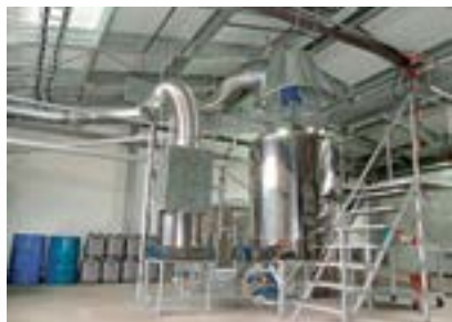
Варочное оборудование в цехе изготовления смазок
