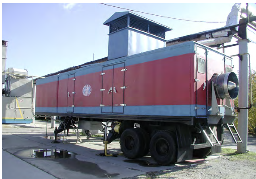
Передвижная электростанция газотурбинная ПАЭС-2500
