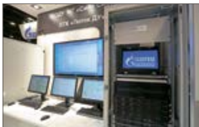
Рис. 2. Макет системы оперативно-диспетчерского управления на базе ПТК «Поток-ДУ»
