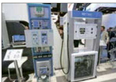
Рис. 1. Колонка заправочная газовая «Эталон-К»
