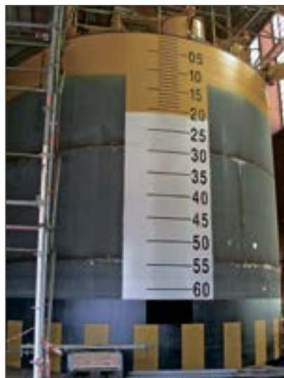
Рис. 2. Стальная свая-оболочка кессонного типа, общий вид Fig. 2. Steel suction pile, general view
