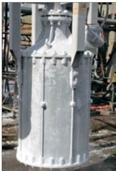
Рис. 3. Электронасос НСПГ 900-120 после проведенных испытаний
