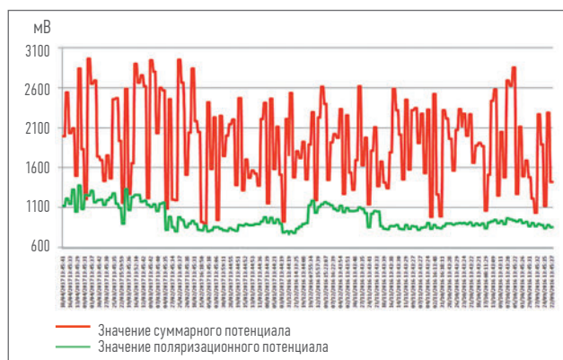
Рис. 3. Показания мгновенных значений суммарного и поляризационного потенциалов на БИП-6 (стабилизация в режиме поддержания защитного суммарного потенциала)
