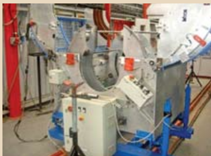
Рис. 1. Установка по нанесению трехслойного покрытия на сварные швы
