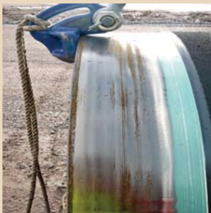
Рис. 6. Труба с оголенным эпоксидным слоем (зеленого цвета)
