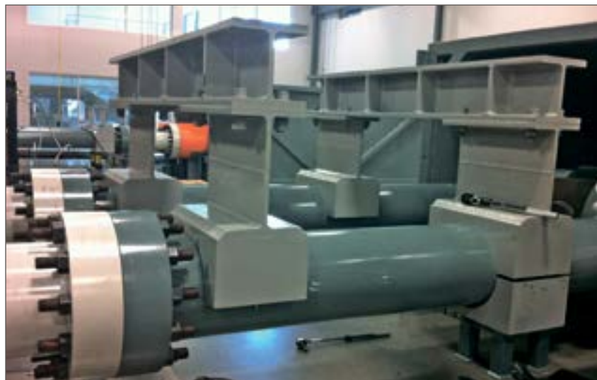
Рис. 3. Общий вид стенда для испытаний резьбовых соединений в соответствии с требованиями ГОСТ Р ISO 13679-2016 Fig. 3. General view of the threaded joints testing stand in accordance with the requirements of GOST R ISO 13679-2016
