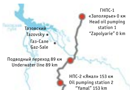
Рис. 4. Схема участка (0–153 км) трубопроводной системы «Заполярье – Пурпе» Fig. 4. Scheme of the section (0–153 km) of the pipeline system "Zapolyarie – Purpe"
