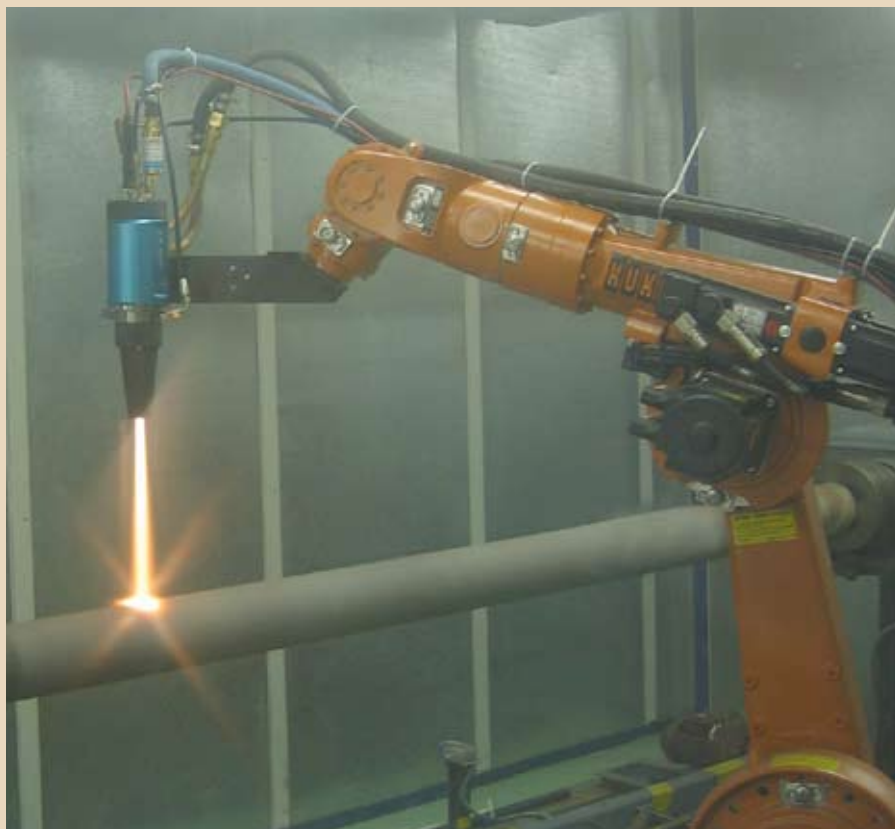
Рис. 1. Нанесение антикоррозионного износостойкого покрытия на корпус электродвигателя УЭЦН
