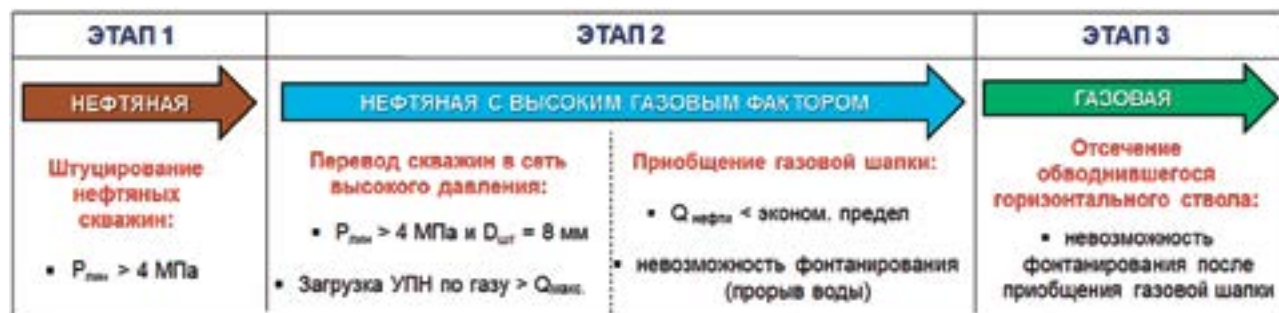
Рис. 8. Этапы эксплуатации многофункциональной скважины
