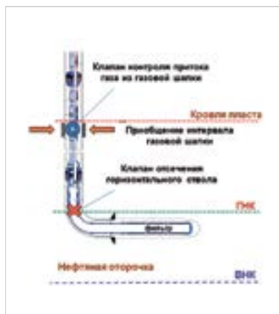
Рис. 1. Принципиальная схема конструкции многофункциональной скважины
