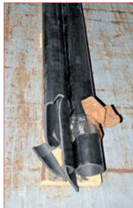
Рис. 2. Разрушение анодного заземлителя при транспортировке
