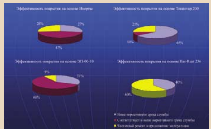
Рис. 11. Сравнительный анализ защитных свойств систем противокоррозионных покрытий
