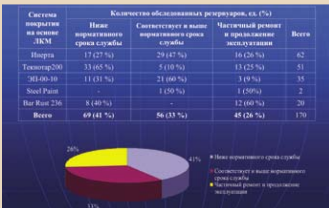
Рис. 10. Сравнительный анализ защитных свойств систем противокоррозионных покрытий
