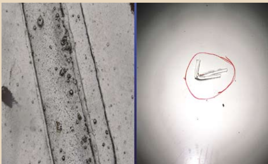
Рис. 6. Брызги сварки и острые кромки
