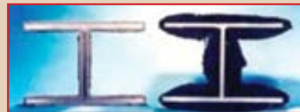
Рис. 2. Под воздействием огня Chartek вспучивается и увеличивает толщину покрытия, образуя изолирующий слой из золы
